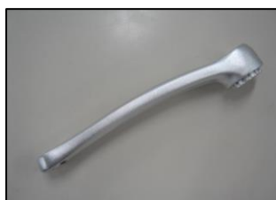
図8 アルミ鍛造品 (一体: 195gf)
