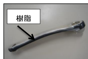
図10 アルミ/樹脂接合品 (肉又スミ構造: 142gf)
